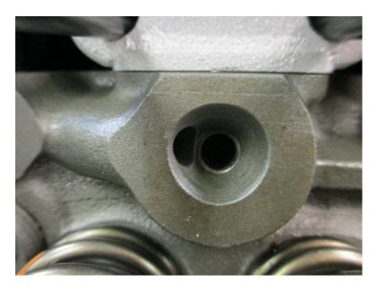
Fig. 4 - Oiling Stud Hole
